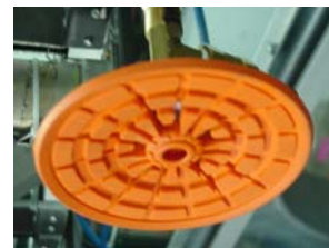
รูปที่ 2 แสดงลักษณะของ suction cup ที่เลือกใช้
