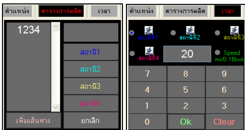
ภาพที่ 7 หน้าต่างสำหรับใส่ค่าลำดับเส้นทางและเวลาการผลิต
