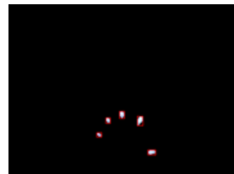
ภาพที่ 4 ภาพที่ได้หลังจากการทำ Blob Analysis
