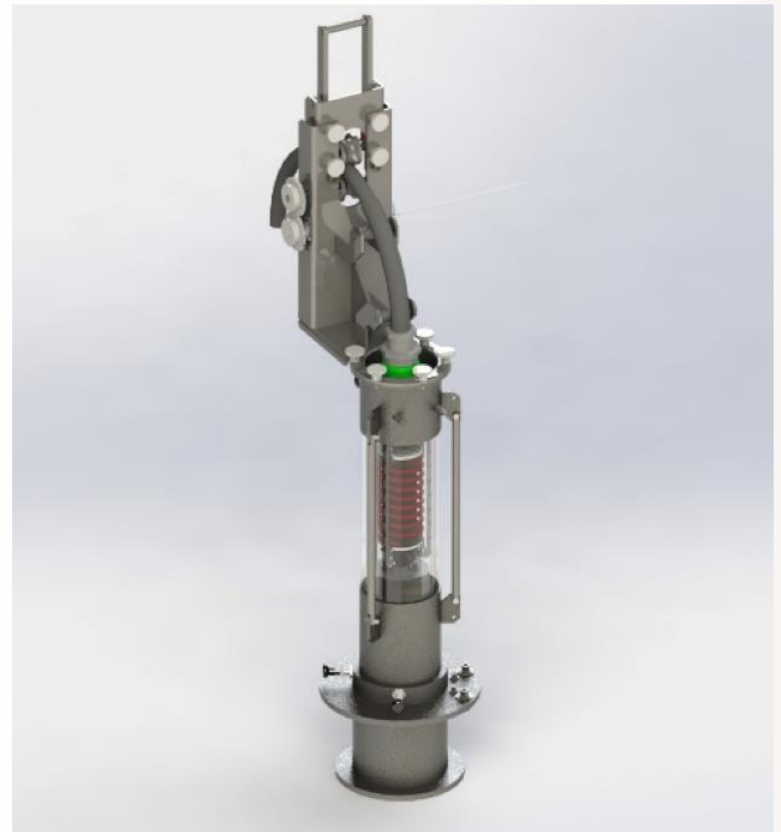
รูปที่ 1 หุ่นยนต์ตรวจคุณภาพท่อ (Tube) โดยการวัดเส้นผ่าศูนย์กลางภายในท่อ
